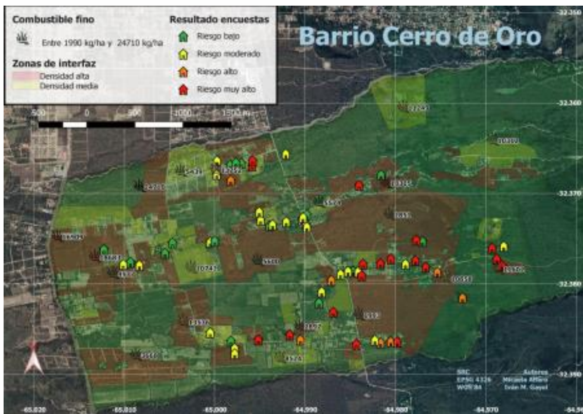
fig. 2. - Resultado del muestreo de carga de combustible y de vulnerabilidad de viviendas.
