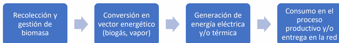
Figura II. Fases de una planta de bioenergía
