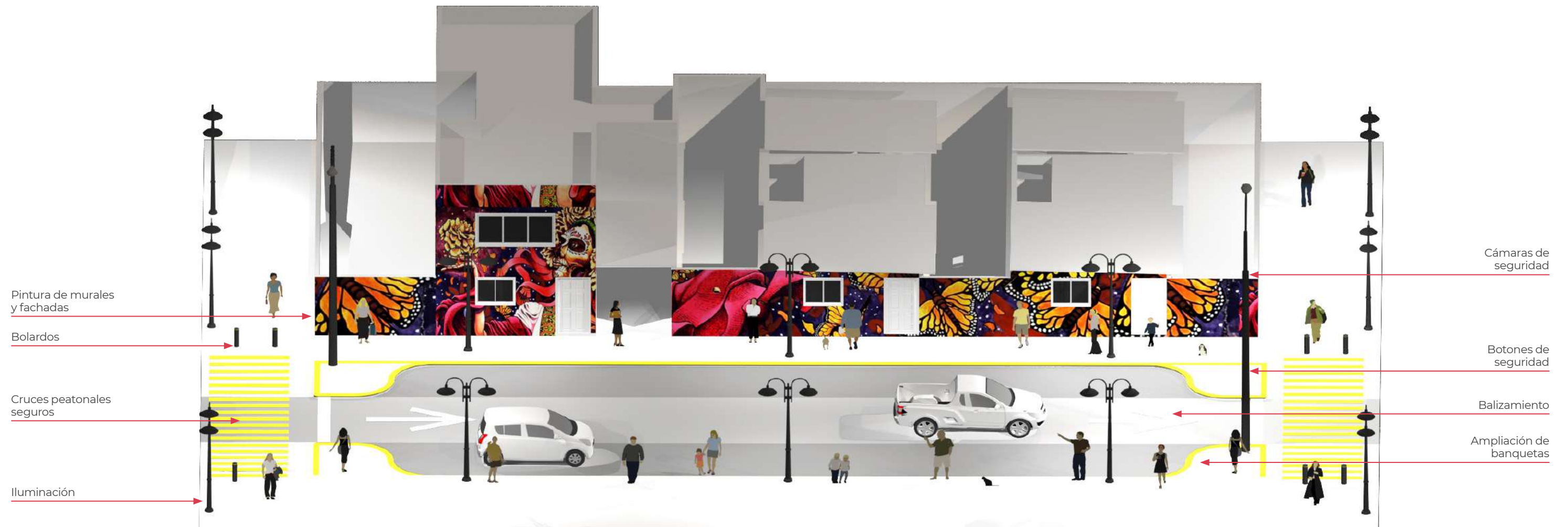
Imagen 31. Ejemplo de intervención intermedia, para calles secundarias o terciarias
