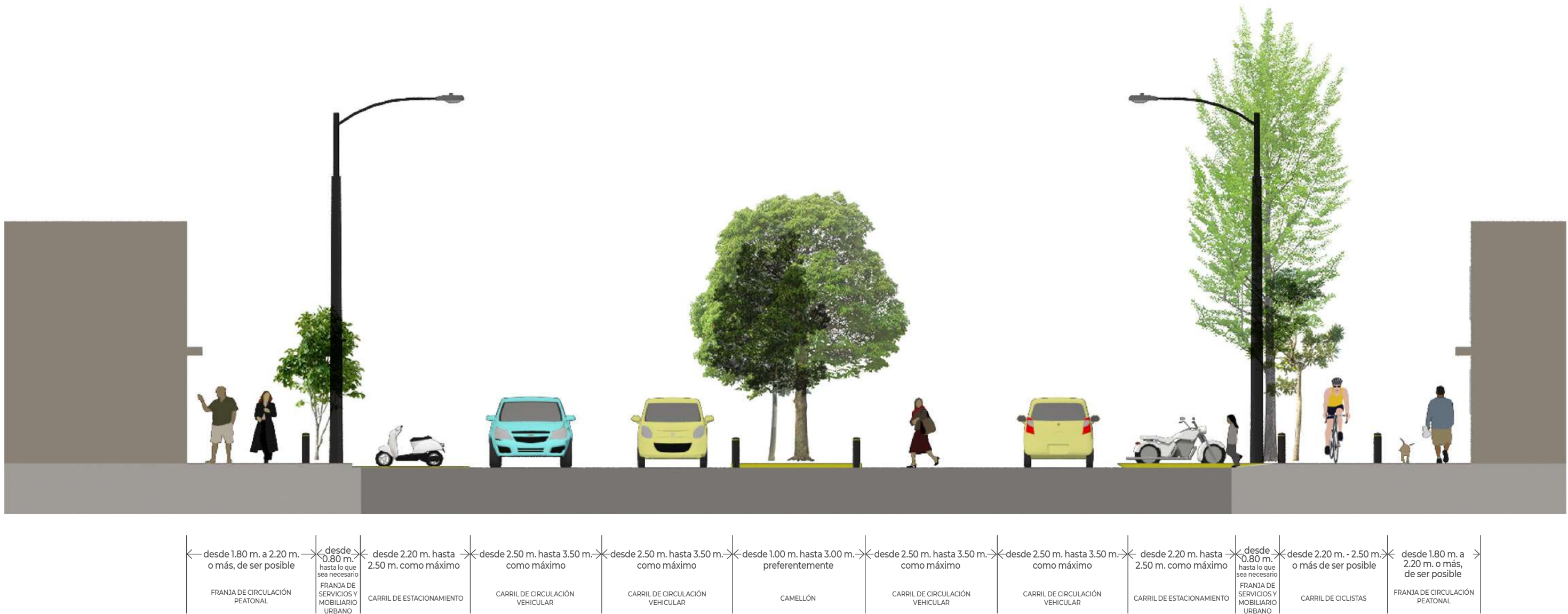
Imagen 30. Sección con medidas sugeridas para una intervención intermedia, en avenidas y calles primarias
