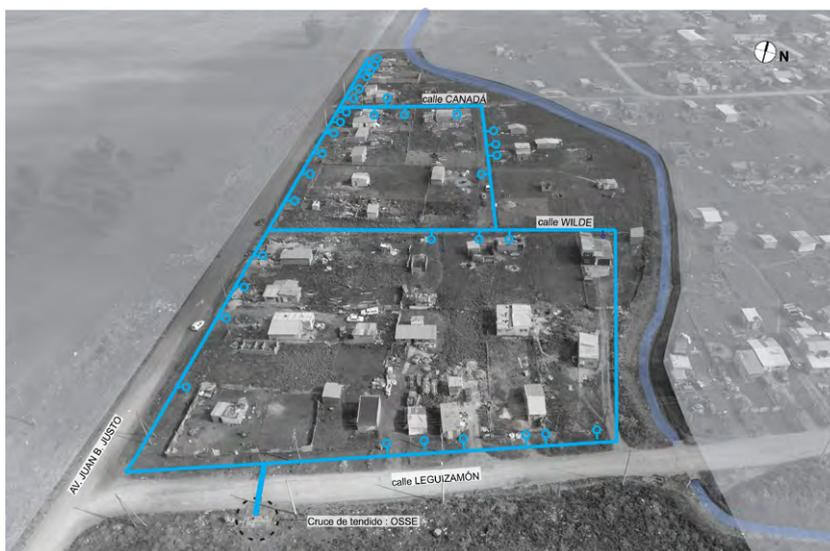
**Figura 9. Red de agua actual.** Fuente: elaboración propia sobre aerofoto tomada por un dron en septiembre de 2020
