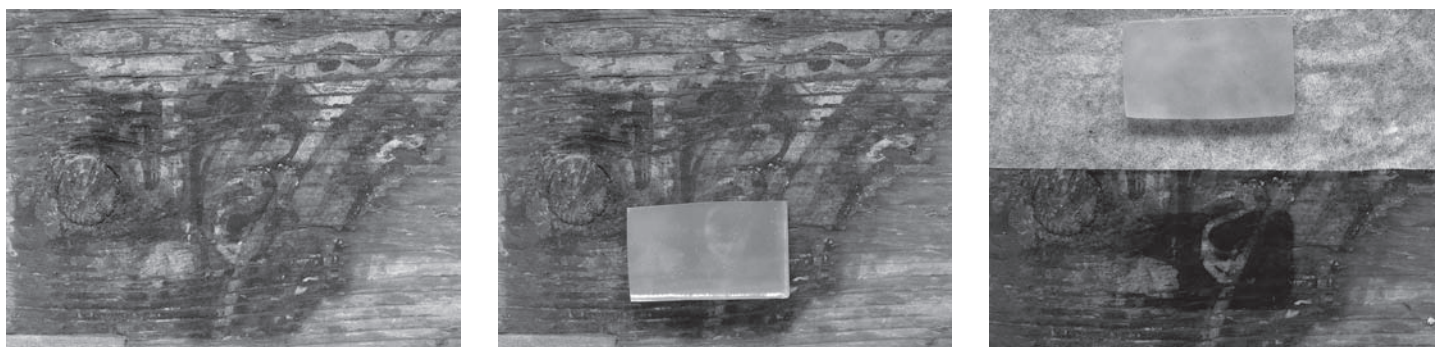
Fig. 3a-b-c. Sequenza dell'applicazione del gel rigido di Agar in una delle tavolette.
