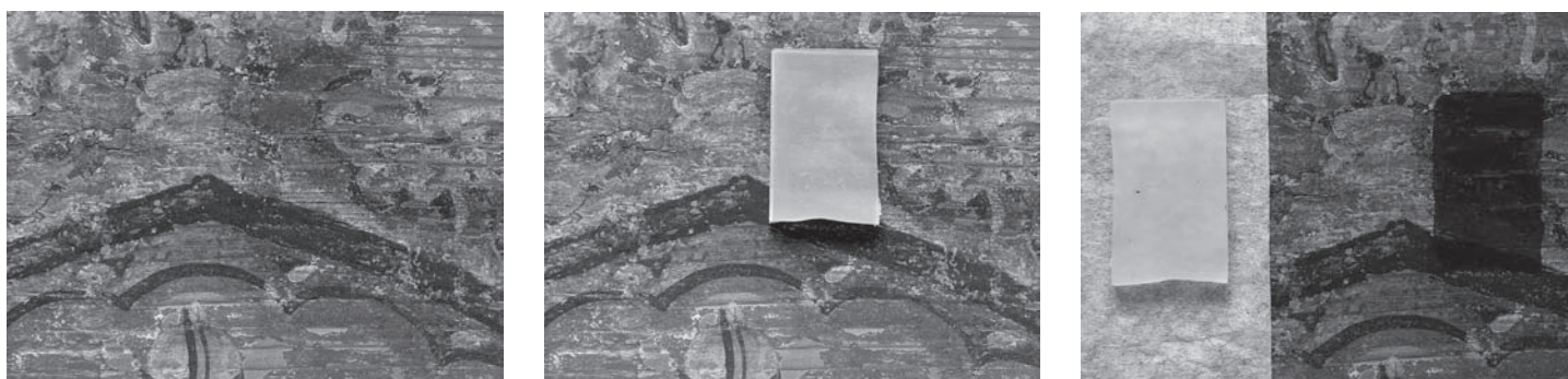
Fig. 4a-b-c. Sequenza dell'applicazione del gel rigido di Agar in una delle tavolette.
