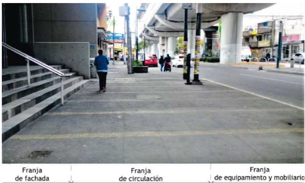
Figura 4.7. Esquema de franjas en la banqueta correspondiente a la estación de la Línea 12 San Andrés Tomatlán
