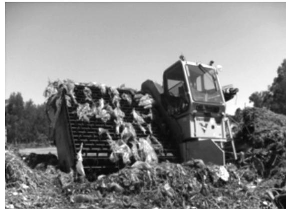
Figuras 6A y 6B. Retiro de los inorgánicos durante el volteo y captura de bolsas de polietileno de baja densidad utilizando una volteadora marca Veermer.
